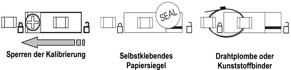
Abbildung 4-1. Sperren und Versiegeln des Kalibrierungssperrschalters
