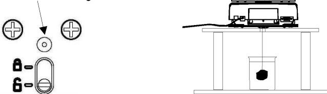
Abbildung 4-2. Einrichtung zur Verwendung des Unterflurwägehakens
