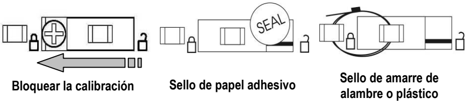
Figura 4-1. Bloqueo y sellado del interruptor del seguro de calibración
