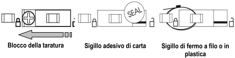
Figura 4-1. Blocco e sigillo dell'interruttore di blocco della taratura
